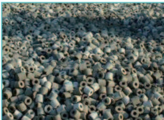
Cylindres béton creux. Porosité 60%
